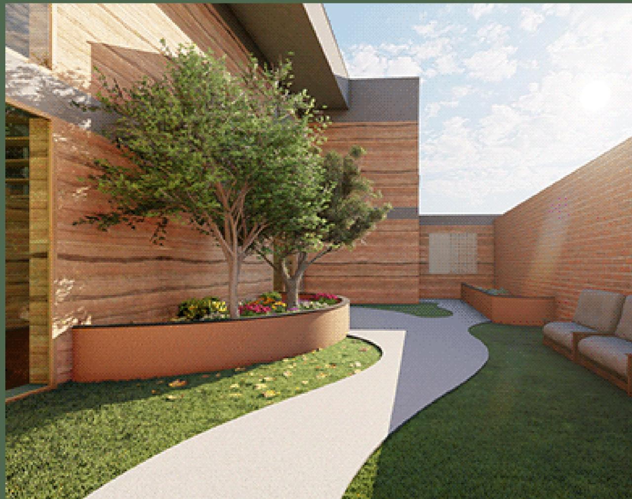
**Taipa de Pilão:** utilizada em igrejas do Brasil colonial. Consiste em barro pilado dentro de formas que denominamos de taipa. As paredes tem em torno de 30 a 120 cm de espessura, e as taipas 2 a 4 metros de comprimento dependendo do projeto.
